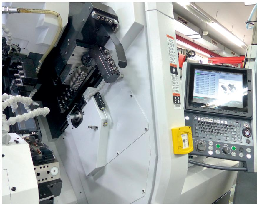
5 Bei den zahlreichen Achsen an Langdrehautomaten wäre für jede Achse ein taktilen Messsystem notwendig. Dafür ist jedoch kein Platz vorhanden © UTtec
