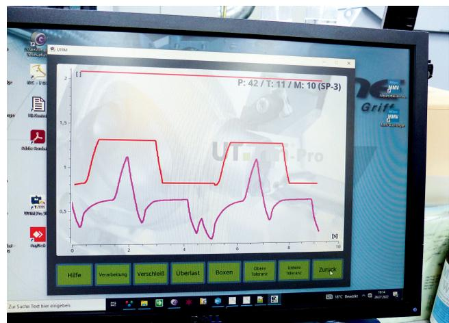
4 Neben der ‘idealen Notbremse’ im Fall eines Werkzeugbruchs lassen sich mit dem Werkzeugüberwachungssystem ‘UT-Tm-Basic’ Schnittkraftgrenzen setzen und klar definieren, wann eine Warnung erfolgt © UT Tec
