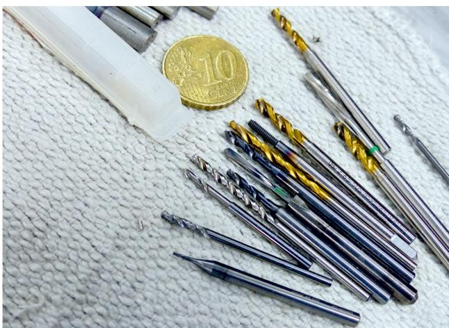
3 Die eingesetzten Werkzeuge mit Durchmessern zwischen einem und drei Millimetern: Selbst ein qualifizierter Maschinenbediener hört es nicht zwingend, wenn ein derartig filigranes Werkzeug bricht © UT Tec
