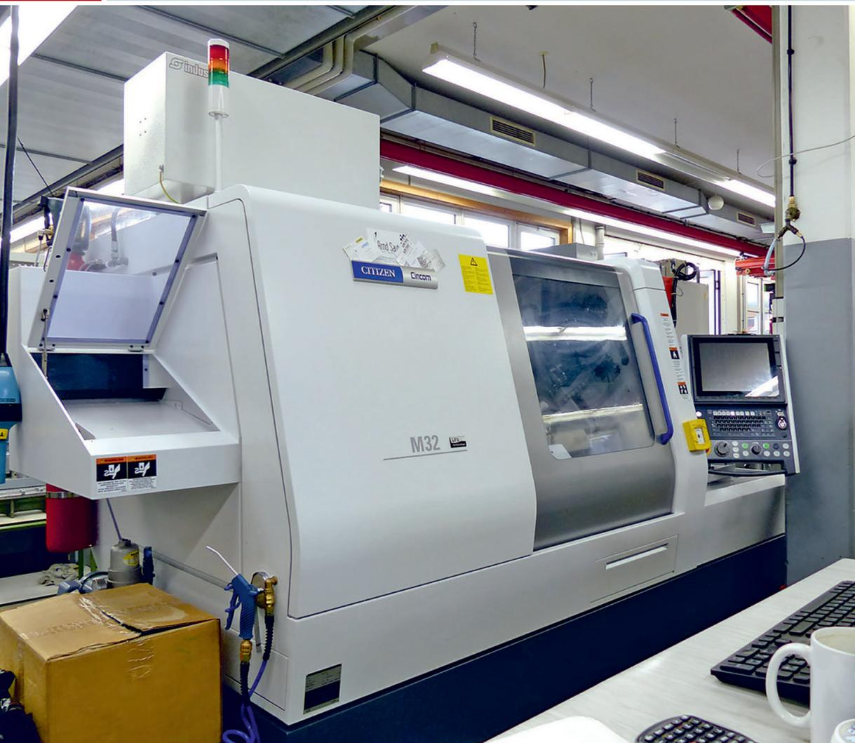
1 Die Robert Höhne Präzisionsmaschinen GmbH & Co. KG hat in einen Cincom-Langdrehautomaten aus dem Hause Citizen Machinery investiert, um Bauteile zu fertigen, die auf einem Kurzdreher nur schwierig zu fertigen sind
